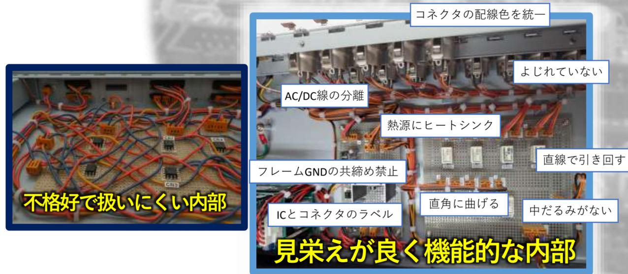
放熱対策、AC/DCの分離、飛び込みノイズ対策、過電流対策、利用状況に適した部品、
